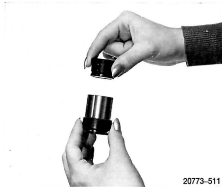
Abb. 16 Einschrauben der Fassung mit Strichplatte in das Okular W 16 x VA
