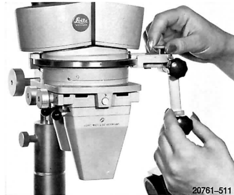
Abb. 5 Montage der Auflichtbeleuchtung
