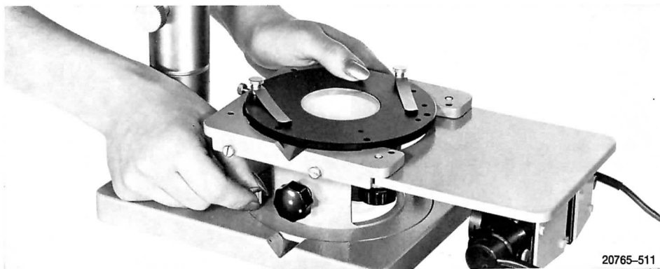
Abb. 6 Montage des Durchlichteinsatzes in den Stativfuß
